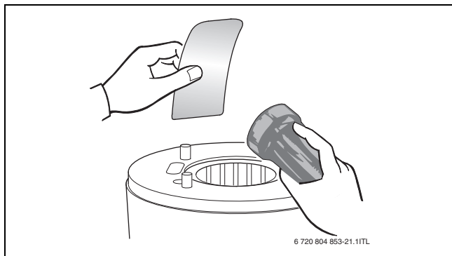
Мал. 65 Перевірка котлового блока, який включає камеру згорання і теплообмінник, на наявність відкладень
