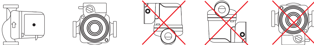
Варіанти установки циркуляційних електронасосів з «мокрим» ротором
