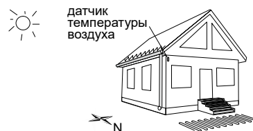
Рисунок 1. Монтаж датчика температуры воздуха
