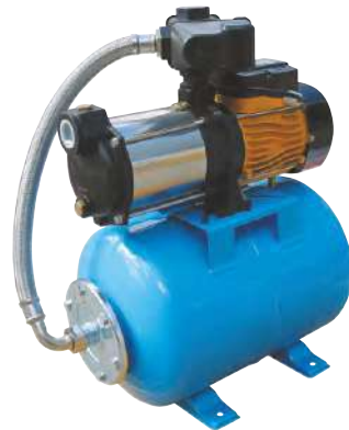
Стандартна комплектація з баком 24 л Напір: 45 м Продуктивність: 8 м³/год Глибина всмоктування: 7 м
