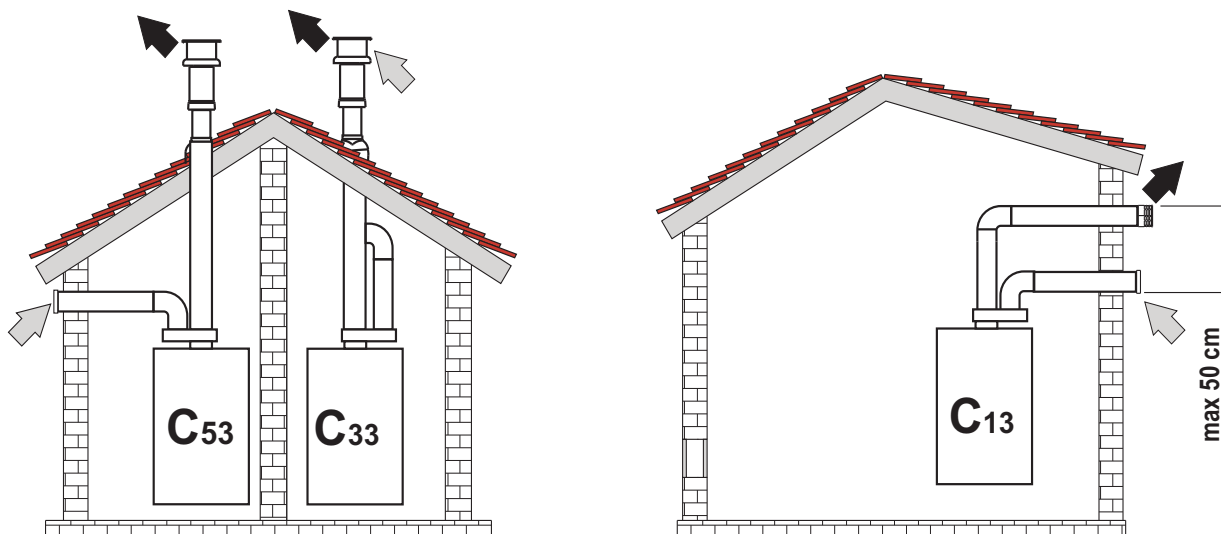
мал. 25- Приклади під'єднання за допомогою відокремлених труб
