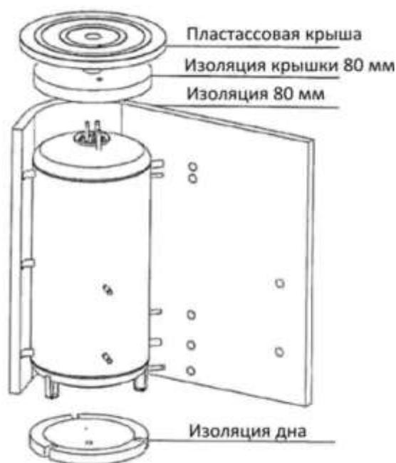
Слой полиэфирного волокна NEODUL толщиной 100 мм. Компоненты изоляции – верхняя крышка, крышка фланцев и заглушки отверстий. Изоляция поставляется в отдельной упаковке.
