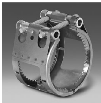
Когтевой хомут CV Хомут защищает от воздействия продольных сил. Используется для всех соединений CV и SE, для давления более 0,5 бар
