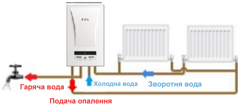
Малюнок 7. Схема підключення монотермічного котла (модель МТ)
