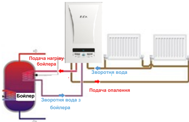
Малюнок 9. Схема підключення котла моделі СТ.
