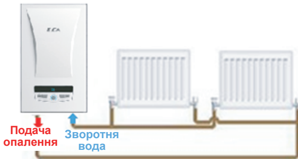
Малюнок 8. Схема підключення котла (модель СН)
