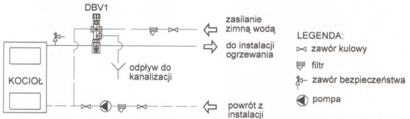
Рис.6 Схема інсталяції з двоканальним запобіжним клапаном DBV1.
