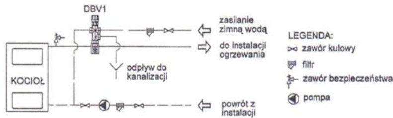
Мал. 3. Схема інсталяції з двоходовим клапаном безпеки DBV1.
