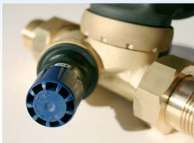
Редуктор давления | Простое защёлкивание: выдвинуть немного колпачок редукционного клапана, установить давление, защёлкнуть колпачок обратно – готово!
