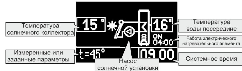
На экране выводятся все важные параметры, относящиеся к работе бойлера и дополнительных отопительных инсталляций. Отображается ясная и полезная информация обо всех измеряемых температурах, часах, как и поле избранной дополнительной информации.
