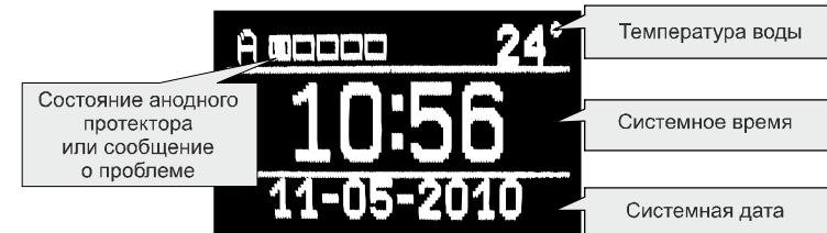
В выключенном состоянии изображаются дата, час, текущая температура воды, измеренная в верхней части бойлера, как и состояние анодного протектора бака. В случае возникновения какой-нибудь проблемы, индикатор о состоянии анодного протектора сменяется по очереди с выводом сообщения о выявленном проблеме, и одновременно с этим можно услышать звуковой сигнал. Когда бойлер в этом состоянии, экран более темный.
