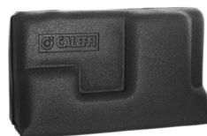
789 Изоляция для серий SATK15. Материал: Пенопласт PE-X сшитый полиэтилен с закрытыми ячейками. Минимальная толщина: 10 мм. Огнестойкость (DIN 4102): класс B2.
