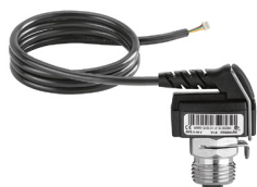
161 Реле давления в комплекте с соединительными кабелями. Рабочий диапазон: 0,5–10 бар. Максимальная рабочая температура: 100 °С. Питающий кабель: 1 м.
